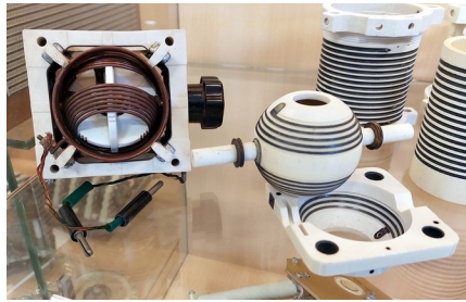
Bild 36: Zwei Kugelvariometer, gewickelt und mit aufgebranntem Leiter
