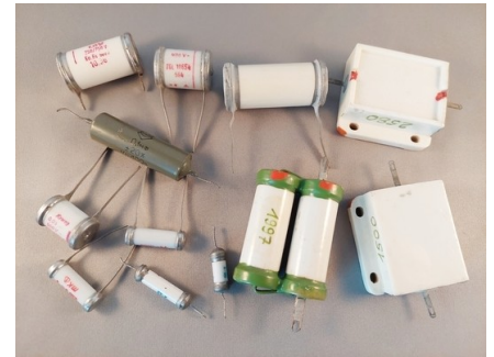
Bild 39: „Tropenfeste“ Kondensatoren mit runden und eckigen Keramikhüllen
