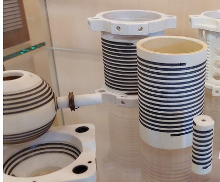
Bild 24: Induktivitäten mit Keramikträger und aufgebrannten Wicklungen, links Kugelvariometer
