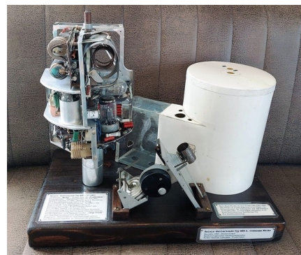
Bild 73: Die Wettersonde als Ausstellungsstück, links die elektronische Baugruppe, mittig die Lang-Sonde und rechts das Kunststoffgehäuse
