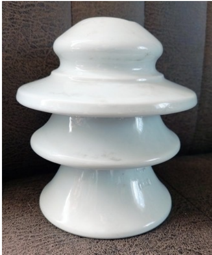
Bild 10: Die „Deltaglocke“. Das Bild zeigt ein späteres Modell aus der Sammlung des Autors, Produktnummer 1383, für 21 kV, hergestellt ab 1912 [09/56].
