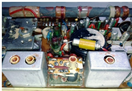
Bild 51: Leiterplatte des RFT Taschenradio T100 mit Keramikgrundplatten in den Bandfiltern
