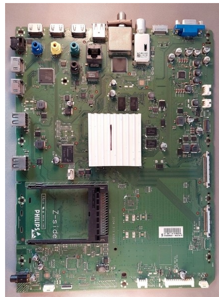
Bild 94: Philips TV-Mainboard mit Keramik-Kühlkörper für die CPU
