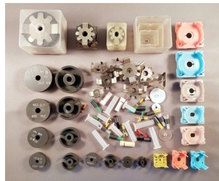
Bild 55: Schalenkerne für Spulen mit hoher Induktivität, als „Bausatz“ gehandelt
