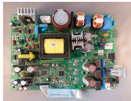
Bild 95: Leiterplatte eines Heimkino-Systems mit Class D Audioendstufen
