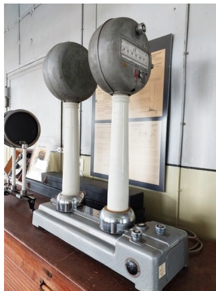
Bild 31: Spiegelgalvanometer mit Keramiksäulen
