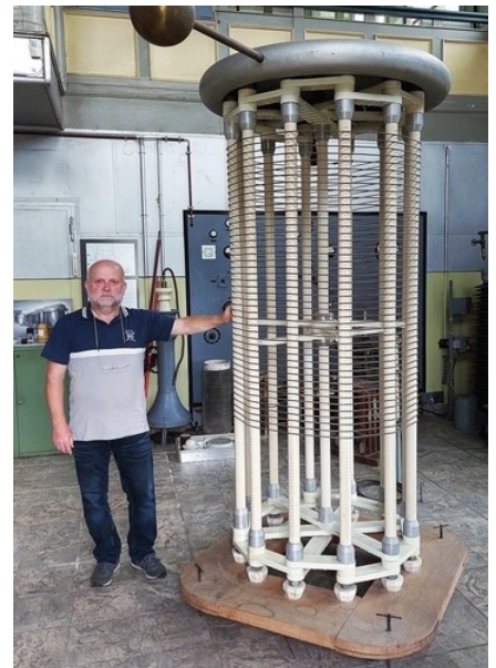
Bild 27: Sekundärspule im 40 kW-Großmesssender, Bild mit dem Autor des Artikels
