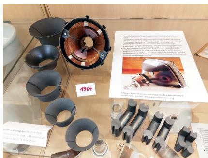
Bild 54: Jochringkerne für Ablenkeinheiten von TV-Röhren und Kerne für Zeilentransfos
