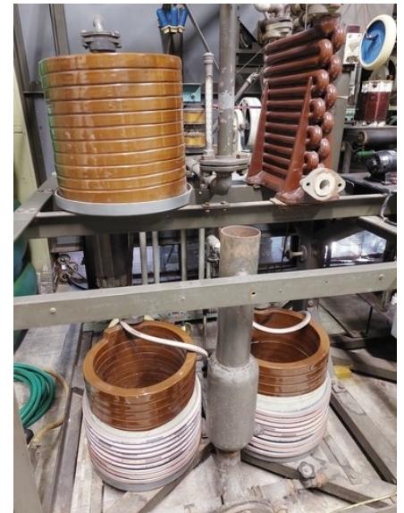
Bild 19: Wasserwiderstände im 40 kW-Großmessender in Hermsdorf
