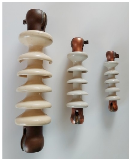
Bild 13: HF Abspannisolatoren für Freilufteinsatz aus 60er Jahren
