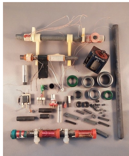
Bild 56: Ferritstäbe, Ringkerne, Lochkerne, Ferritperlen für HF- und Entstör-Filter
