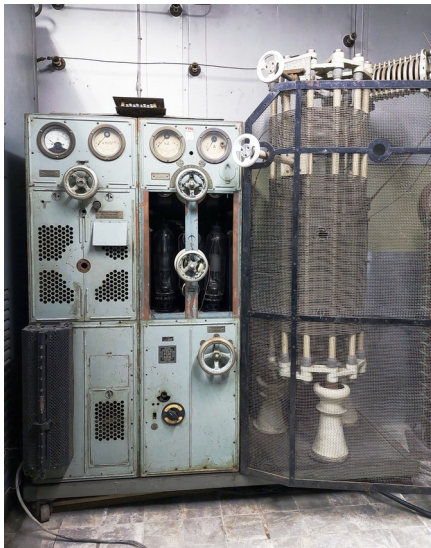
Bild 12: Telefunken Sender mit Ausgangsspule für Prüfstrecke
