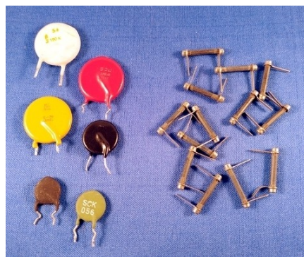
Bild 47: Varistoren, rechts Zündwiderstände für Quecksilberdampf Lampen
