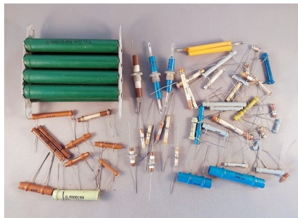
Bild 37: Rohrkondensatoren, links hoher Kapazitätswert, in der Mitte Durchführungskondensatoren und rechts niedriger Kapazitätswert
