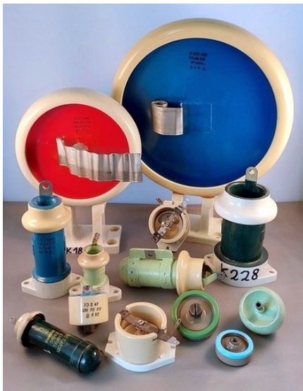
Bild 16: Scheibenkondensatoren und Rohrcondensatoren für hohe Spannungen
