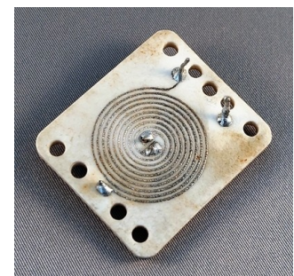
Bild 33: Aufgedruckte Spule mit 8,0 µH Induktivität
